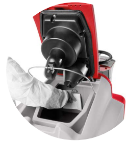
En cas de chocs accidentels, rétraction automatique du carter et décrochage automatique du suceur
